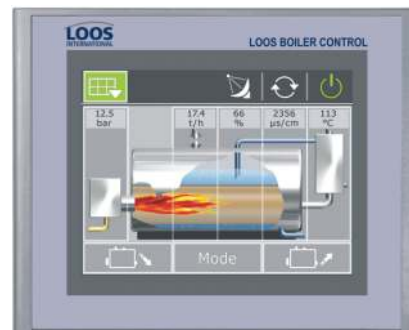
Сенсорный экран системы управления котлом LBC «LOOS BOILER CONTROL»
